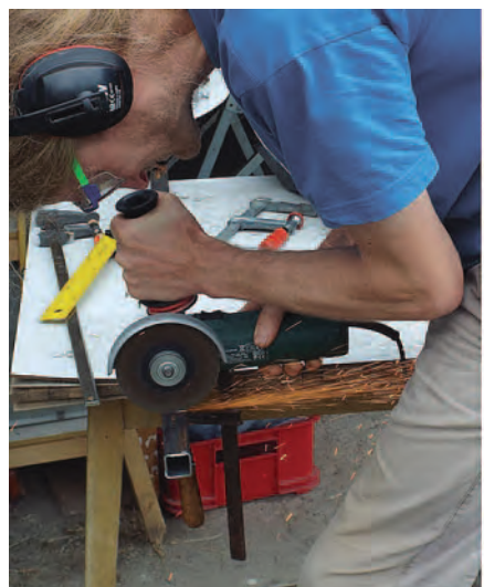
Arbeiten an der Lehmziegelpresse – Alles wird aus Stahl geflext, geschraubt und verschweißt.
