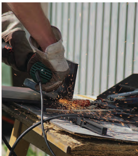
Arbeiten an der Lehmziegelpresse – Alles wird aus Stahl geflext, geschraubt und verschweißt.
